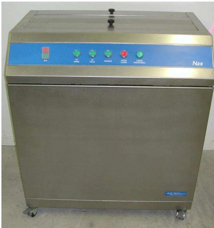
Spécialement conçue pour mettre en valeur le système MPC® (Micro Phase Cleaning) du Vigon SC200, le pochoir immergé verticalement, soumis à l'action d'ultrasons perpendiculaires, est parfaitement nettoyé en quelques minutes. Le sécheur indépendant permet de travailler en temps masqué.
